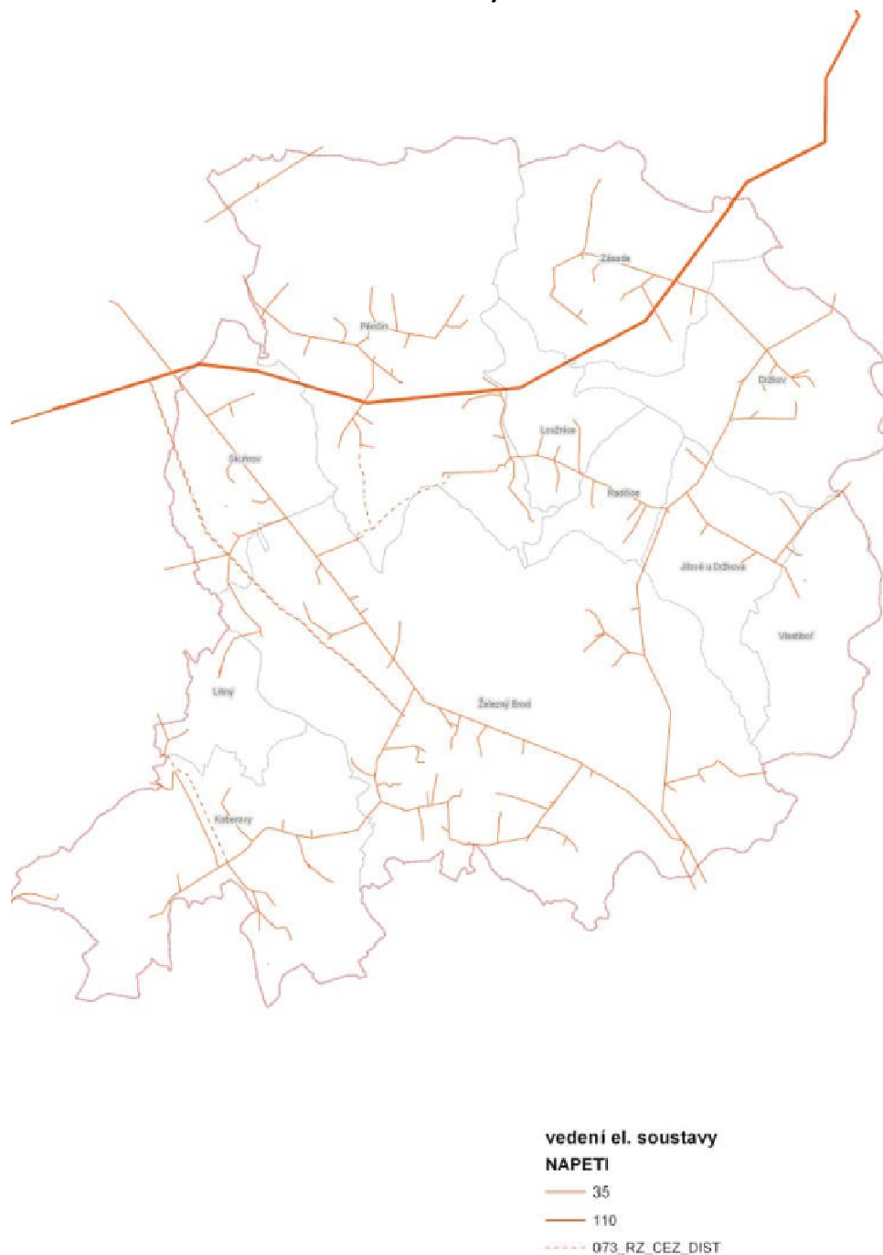
Obrázek č. 5: elektrosoustava v ORP Železný Brod
